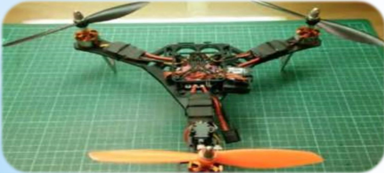
Трикоптер и сервопривод отклонения его хвостового ротора
