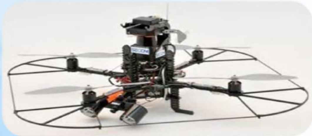
Квадрокоптер с защитой пропеллеров (вверху - GPS-модуль)
