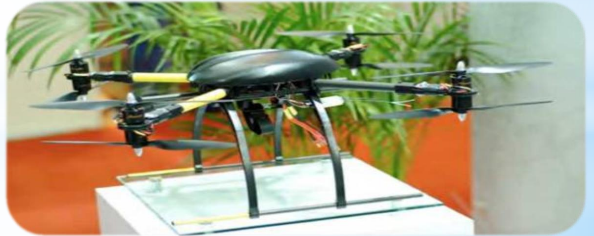
Квадрокоптер схемы «х» с совмещенными тянущими и толкающими винтами
